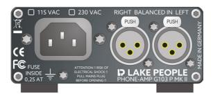
Die symmetrischen Signaleingänge befinden sich auf der Rückseite des Gehäuses und sind mit "BALANCED IN" "LEFT" und "RIGHT" bezeichnet und als XLR-Buchsen ausgeführt.
